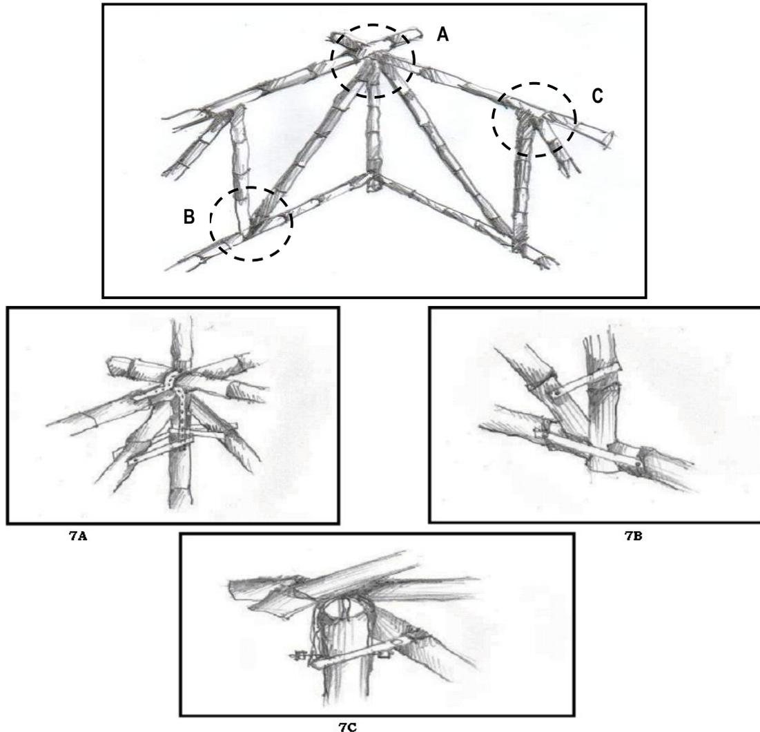
FIGURE 7. CORNER BRACING
