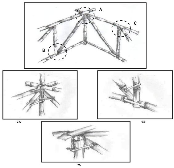
FIGURE 7. CORNER BRACING
